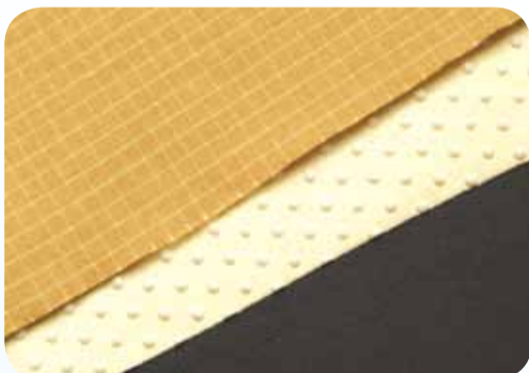
• 防火衣由多層物料組成（外層：防火抗熱布、中層：隔熱防水層、內層：裡布） Composition of fire tunic material
